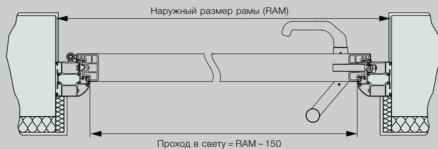
Горизонтальный разрез бокового элемента
