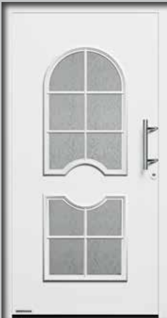
Мотив 413 Ручка из нерж. стали 14-2, орнаментное стекло Silk, тройное теплоизоляционное остекление WSG, показатель U_D до 0,9 \text{ Вт}/(\text{м}^2\cdot\text{К})^*
